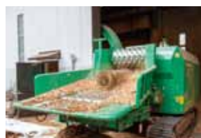
③木材チップパー(破砕機)でチップ製造
