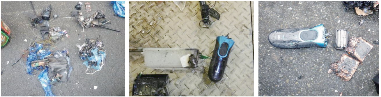
(処理中に発火したリチウムイオン電池の例：西秋川衛生組合内で発生)
