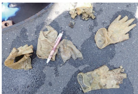
▲ポンプに詰まった異物
