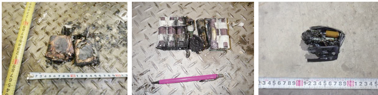
(処理中に発火したリチウムイオン電池の例：西秋川衛生組合内で発生)
